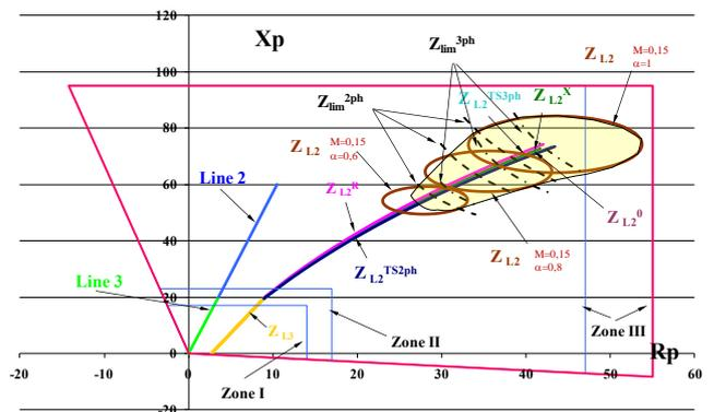
Fig.7 Impedancja pomierzona przez zabezpieczenie AP6 podczas zwarcia łukowego w linii 2 i dodatnim kącie  $\delta_{31}$
